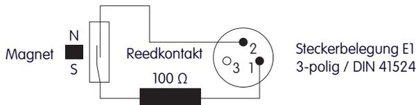
Schaltspannung: U<sub>max</sub> = 24 V
