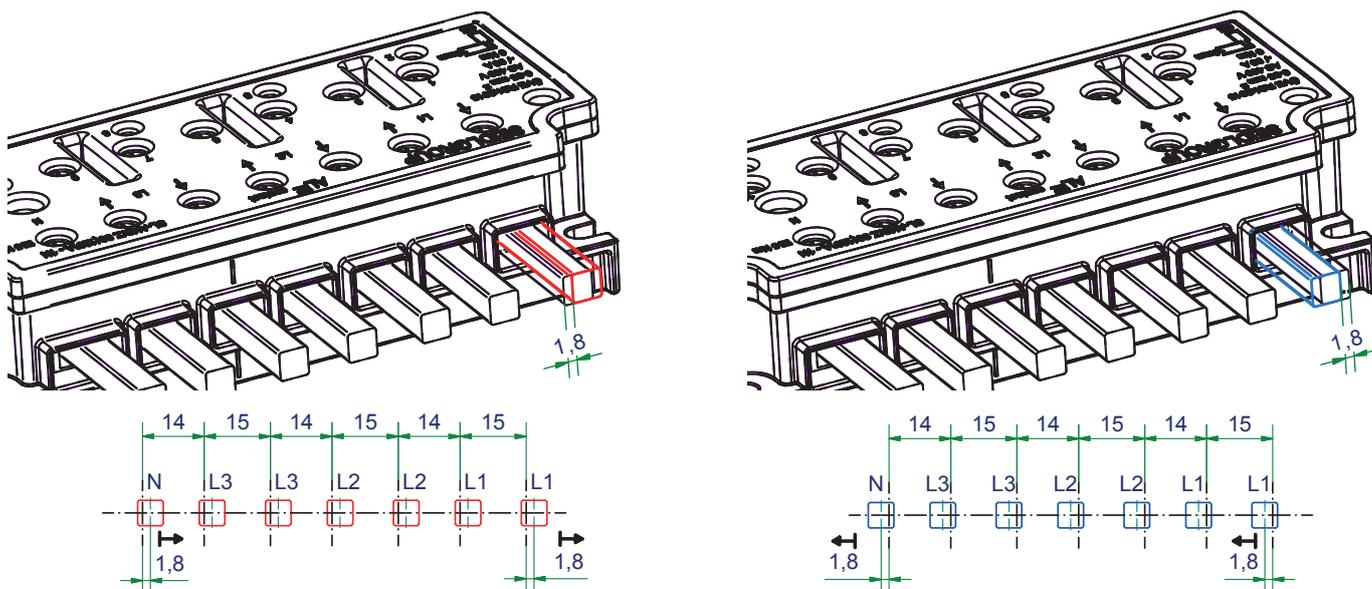
La caractéristique unique et en même temps innovante est le décalage latéral des broches de connexion des compteurs jusqu'à 3,6 mm (1,8 mm par côté). Cela permet de connecter tous les compteurs d'énergie et les compteurs SMART actuellement utilisés au bloc terminal SL-ZAKD.
