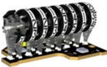
Le mécanisme compteur GWFcoder® : notre technologie clé pour des compteurs de gaz et d'eau intelligents et durables.
